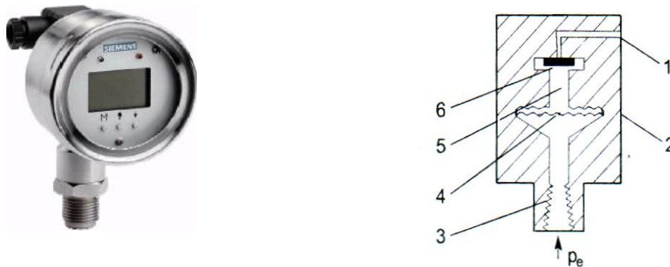
Рис. 2.8. Вимірювальний перетворювач надлишкового тиску SITRANS P, серія ZD: a –зовнішній вигляд; б – функціональна схема вимірювальної комірки: 1– еталонний тиск; 2– вимірювальна комірка; 3 – штуцер підключення до процесу; 4 – розділювальна мембрана; 5– наповнювальна рідина; 6 – кремнієвий сенсор тиску; p_e – вхідна величина тиску
